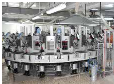
▲ Одна из пяти машин DESMA для изготовления обуви литьевого метода крепления подошвы
