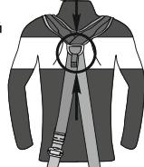
Рис. 9. Правильное крепление соединительного карабина
