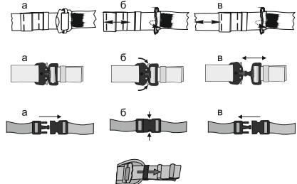
Рис. 6. Надевание привязи «Энерго»
