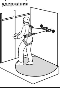
Рис. 14. Позиционирование в рабочем положении
