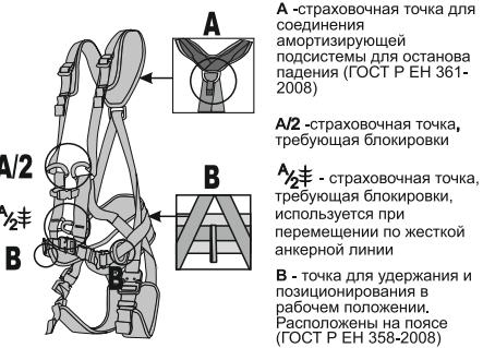
Рис. 2. Расположение и предназначение точек
