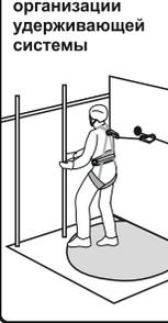
**Рис. 13. Позиционирование в рабочем положении**
