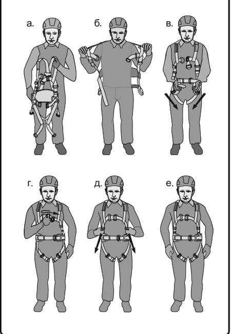
**Рис. 6. Типы используемых пряжек, способы заправки**
