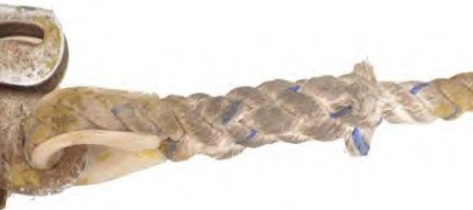
Отсутствие термоусадки для защиты основных швов
