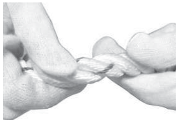
Визуально осмотрите все части каната
