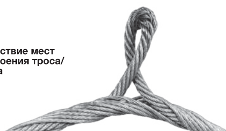
Проверьте отсутствие мест пушения троса/каната
