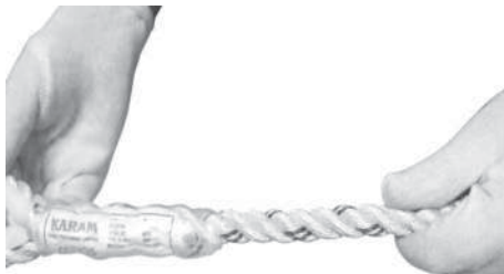
Проверьте читаемость, актуальность маркировки и ее состояние
