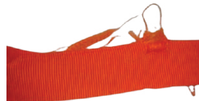
Проверьте на отсутствие порезов, пушения текстиля
