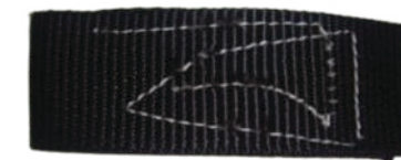
Повреждение химическими элементами, краской
