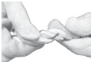
Визуально осмотрите все части каната
