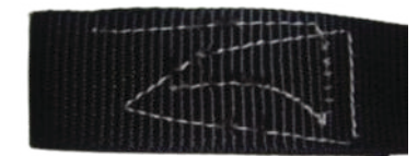
Повреждение химическими элементами, краской
