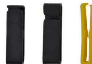
Деформация, плавление, химическое воздействие
