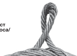
Проверьте отсутствие мест пушения троса/каната
