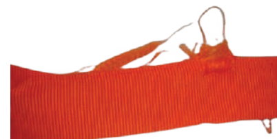
Проверьте на отсутствие порезов, пушения текстиля
