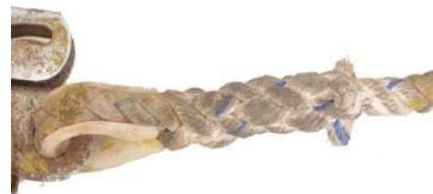
Отсутствие термоусадки для защиты основных швов
