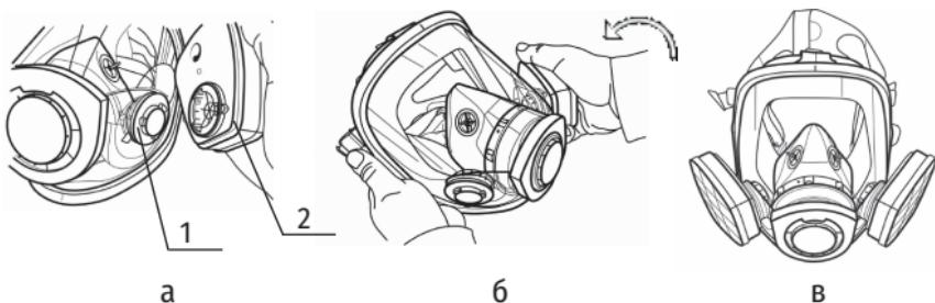
1 – выступ на опорном фланце седловины клапана;
