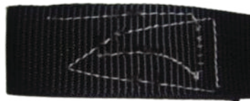
Повреждение химическими элементами, краской
